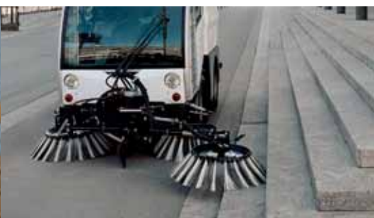
Balai hydraulique incliné
