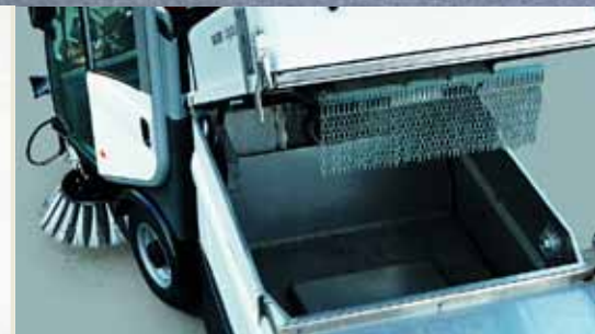
Cuve à déchets
