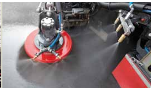
Wasserdüsenpaket zur perfekten Feinstaubbindung (PM 10) - Option
