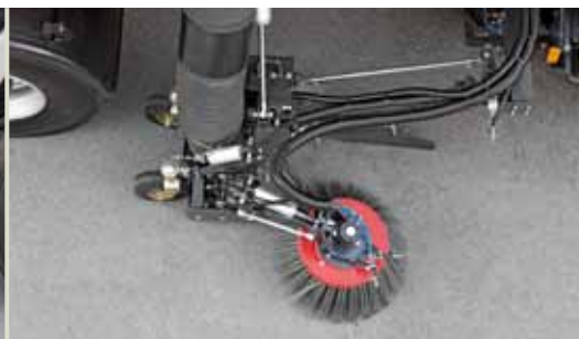
Flexible Kehrbreite - teleskopierbares Kehrgutaufnahme-Aggregat
