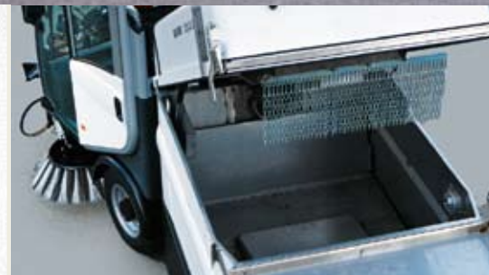
Cuve à déchets
