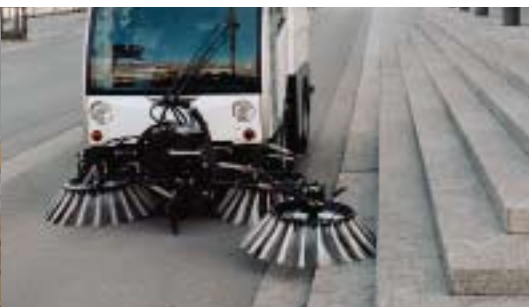
Balai hydraulique incliné
